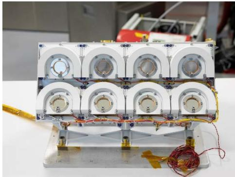
Le laboratoire d'expertise du CNES, avec l'aide de ses partenaires THALES et ELEMCA, a apporté un support à l'IRAP et au fabricant des détecteurs. Après avoir mis en évidence la défaillance par des analyses optoélectroniques (courbes IV, LBIV), différentes analyses (optique, MEB, FIB, SIMS) nous ont permis de caractériser la couche mince en aluminium et ses défauts.
